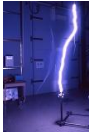
Longueur : 2070 mm Tension : 960 kV
