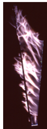
Échelle de Jacob Tension : AC, 25 kV Limitation série : 100 pF
