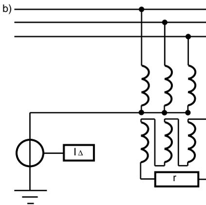
fig. 4 : mise à la terre du neutre d'un réseau avec un transformateur à couplage étoile-triangle associé à :
