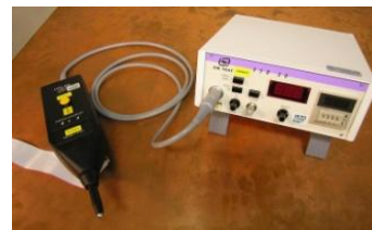
Générateur réel avec un doigt normalisé, selon norme CEI : 61000-4-2
